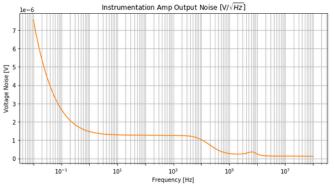
Output RMS Noise (0.01Hz - 100MHz) : 1.29 mV
